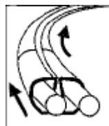
Palástvezető sín (műanyag) csatlakoztatása műanyag tiplikkel
